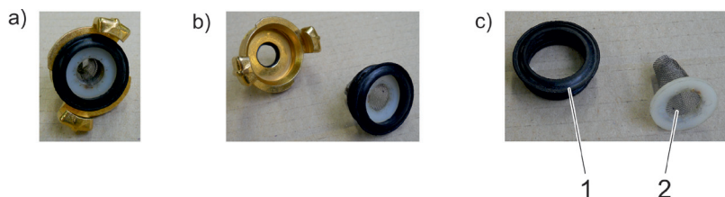
Рис. 18: Техобслуживание входа для воды
